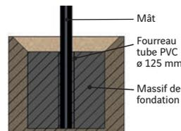
avec massif + embase ø76 + 4 tiges d'ancrage
