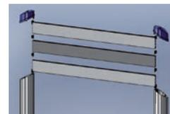
2- En pose frontale, elles sont fixées par des inserts intégrés au dos des lattes.
