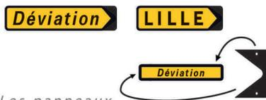
Les panneaux KD21 ou KD22 peuvent être équipés d'une flèche amovible pour permettre l'interchangeabilité des directions des flux de Déviations.
